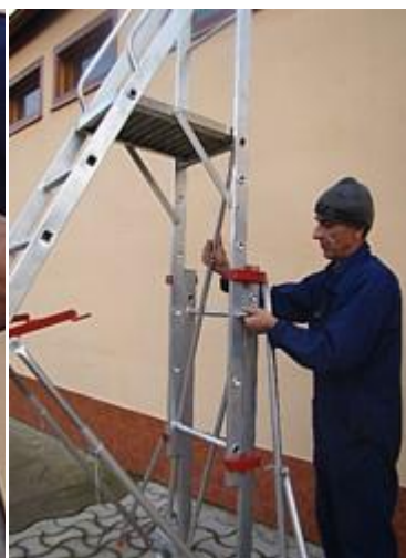
Se coboara longeronul interior cu o treapta
