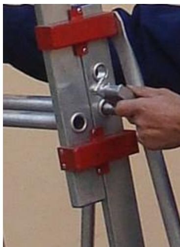
Se trece la partea din spate Se deblocheaza furcile
