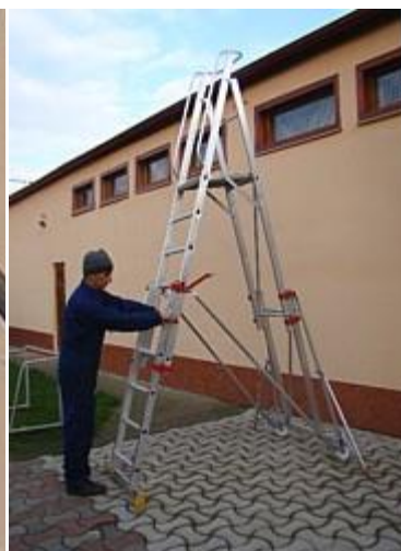
Se deplaseaza longeronul din interior cu o treapta
