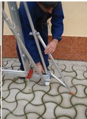
Se blocheaza estacadele prin strangerea celor 4 piulite fluture
