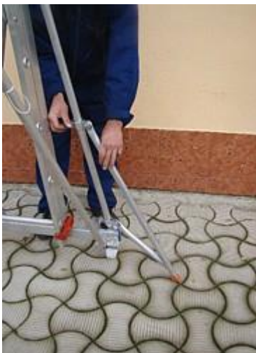
Se pozitioneaza estacadele la sol la unghiul dorit
