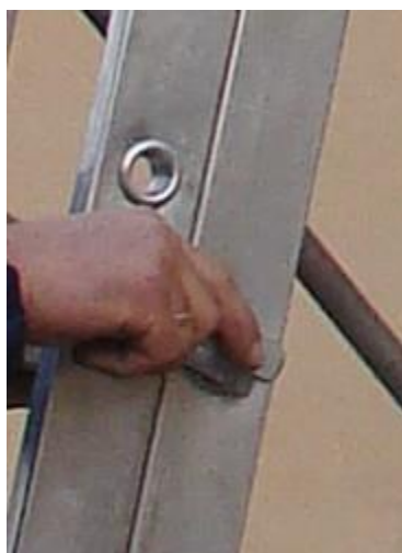
Se trece la partea din spate Se deblocheaza furcile
